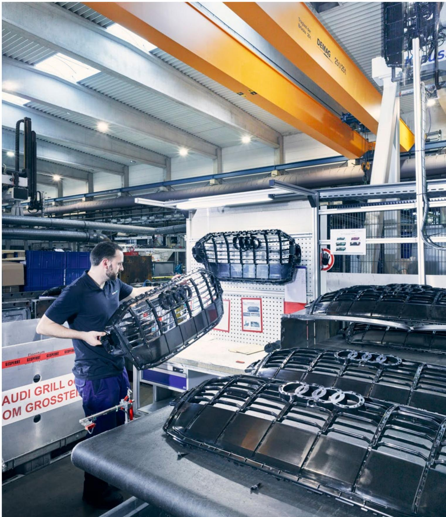
Kontinuierliche Produktionskontrolle an der Spritzgießmaschine bei Winning Plastics Diepersdorf. Produktion des Kühlergrills für den Audi Q3
